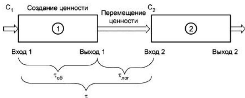
① - процесс-поставщик; ② - процесс-потребитель;  $C_1$  - ценность на входе процесса-поставщика;  $C_2$  - ценность на входе процесса-потребителя;  $\tau_{об}$  - время обработки детали в процессе;  $\tau_{лог}$  - время перемещения детали от выхода процесса-поставщика на вход процесса-потребителя
